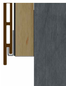
Start profiel en de eerste WEO® Classic plank gemonteerd op een houten achterconstructie
